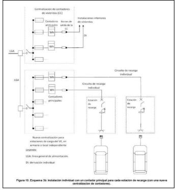
Para la selección entre los esquemas 3a y 3b, se aplicarán los siguientes criterios de prioridad, en primer lugar se utilizarán los módulos de reserva de la centralización existente (esquema 3a), si ello no fuera suficiente se ampliará la centralización existente utilizando también el esquema 3a, en último caso y por falta de espacio, se dispondrán una o varias centralizaciones nuevas en armarios o locales (esquema 3b).
