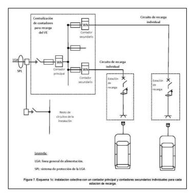
La protección de los circuitos de recarga se puede realizar con fusibles o con interruptores automáticos. La centralización de contadores para recarga del vehículo eléctrico puede formar parte de la centralización existente o disponerse en una o varias centralizaciones nuevas en armarios o locales.
