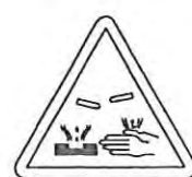
Riesgo de corrosión: Sustancias corrosivas
